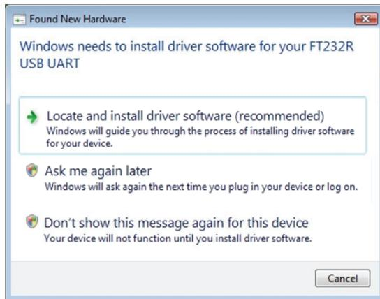
内包されている CD を CD/DVD ドライブに挿入すると、Windows が自動的にドライバをインストールします。Windows が自動的にドライバを確認できない場合、ブラウザ方式で CD/DVD ドライブ及びフォルダ(FTDI USB Driver)を指定してください。
